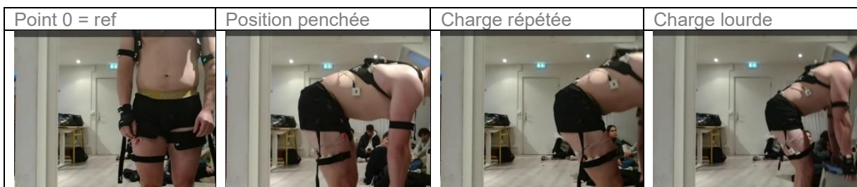
Figure 4 : Différentes étapes du protocole, ici avec exosquelette Percko®
